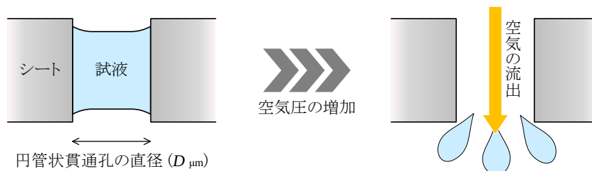
図 2 円管状貫通孔からの空気の流出
