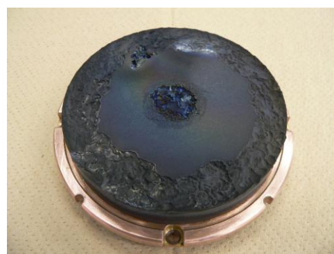
図 2 CVA 法 による成膜を実施した後のターゲット外観
