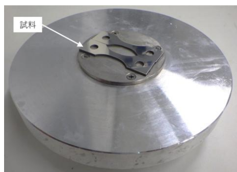
図 4 フラットホルダ（全体荷重）での研磨例
