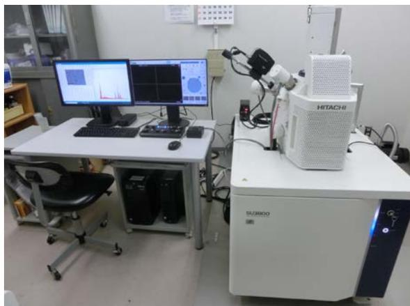
図 1 走査電子顕微鏡本体の外観
