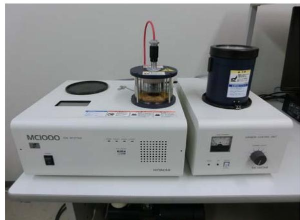
図 2 イオンスパッタ装置の外観
