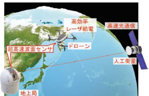
30. 地上・衛星間光通信の超高速・大容量化にむけた超高速波面計測技術
