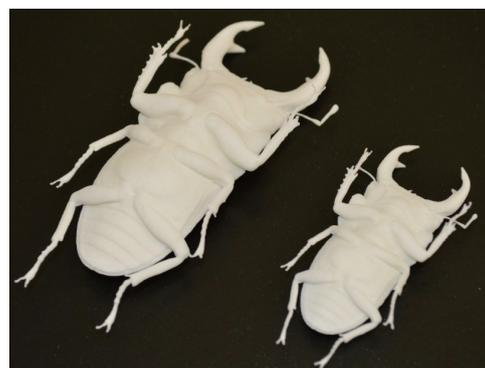
(b) X線CTデータからの形状データを用いたクワガタムシの拡大モデル
